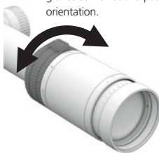
Position de l'image 2, changeur de grossissement
